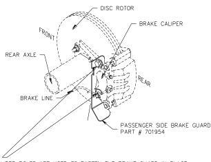
FACTORY CALIPER BOLTS ARE USED TO FASTEN THE BRAKE GUARD IN PLACE LOOSE BOTH FACTORY CALIPER BOLTS TO INSTALL THE BRAKE GUARD SAME INSTALLATION FOR DRIVER SIDE
