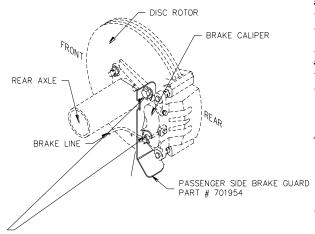
FACTORY CALIPER BOLTS ARE USED TO FASTEN THE BRAKE GUARD IN PLACE LOOSE BOTH FACTORY CALIPER BOLTS TO INSTALL THE BRAKE GUARD SAME INSTALLATION FOR DRIVER SIDE
