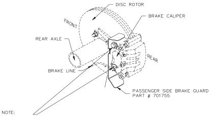
FACTORY CALIPER BOLTS ARE USED TO FASTEN THE BRAKE GUARD IN PLACE LOOSE BOTH FACTORY CALIPER BOLTS TO INSTALL THE BRAKE GUARD SAME INSTALLATION FOR DRIVER SIDE
